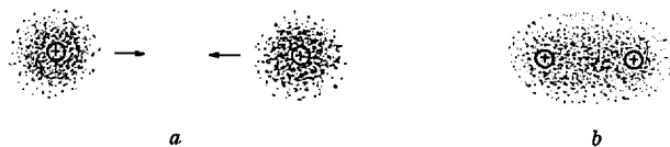
Abb. 7. Zwei Wasserstoffatome (Abb. 7a) treten zum Wasserstoffmolekül (Abb. 7b) zusammen. Die Elektronenwolke im Wasserstoffmolekül kann man sich durch Überlappung und Verschmelzen der beiden atomaren Wolken entstanden denken.
